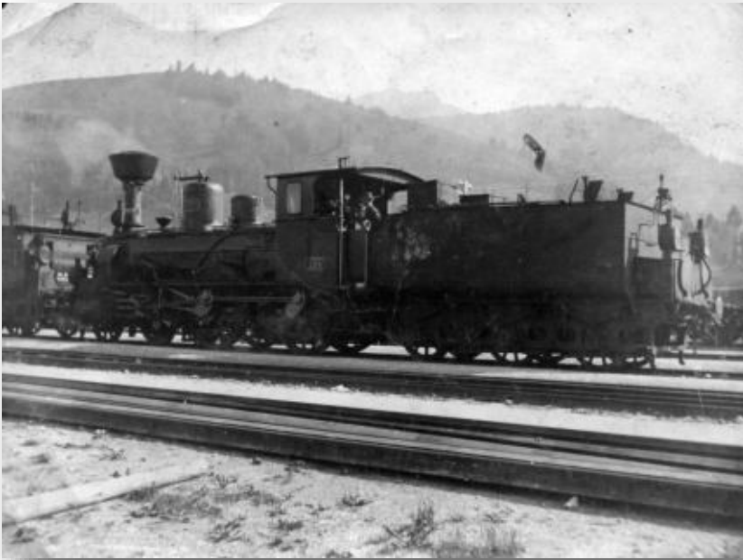
1880 die über 35t schwere Schnellzuglok vom Typ 1.2 der Floridsdorfer Lokomotivenfabrik am Bahnhof in Hochfilzen
